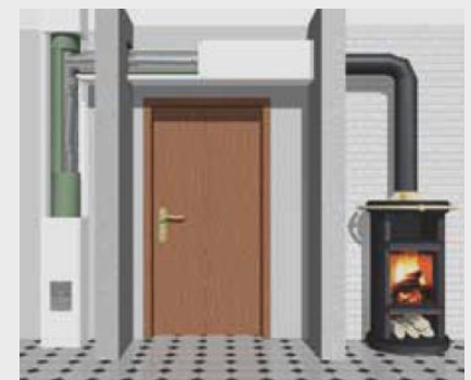
Slika 10: primer rešitve horizontalna povezave.
