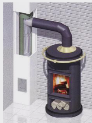
Slika 11: Novo kurišče si lahko postavimo precej svobodno in neodvisno od obstoječega sistema dimnika, saj lahko nov dimnik postavimo skoraj brez omejitev.
